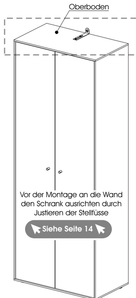
Wandbefestigungen immer unbedingt durchführen und die Schränke und Korpusse lotgerecht ausrichten! Nur so ist gewährleistet, dass die Fronten korrekt eingestellt werden können.
